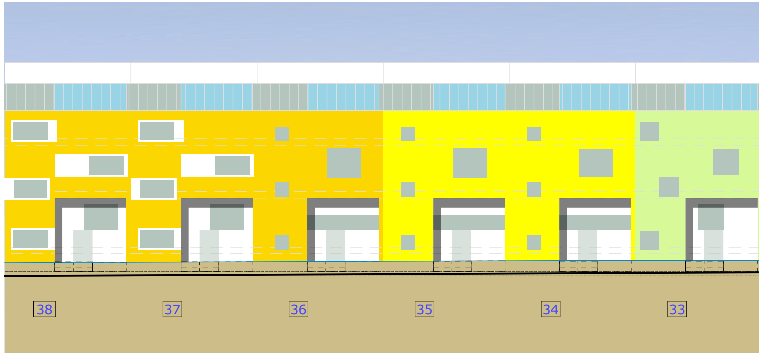
Ansichten entlang der B388/Dorfener Straße - Parzelle 33 bis 38 Fasadengestaltung (Öffnungen) exemplarisch - siehe auch Leitlinie Fassade
